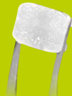
nano-textílie napuštěná adhezivem na bazi zámku
